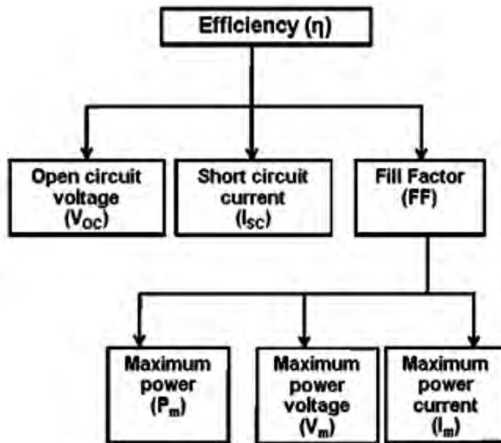
Fig. 3.5.2 Solar PV Module characterisation
