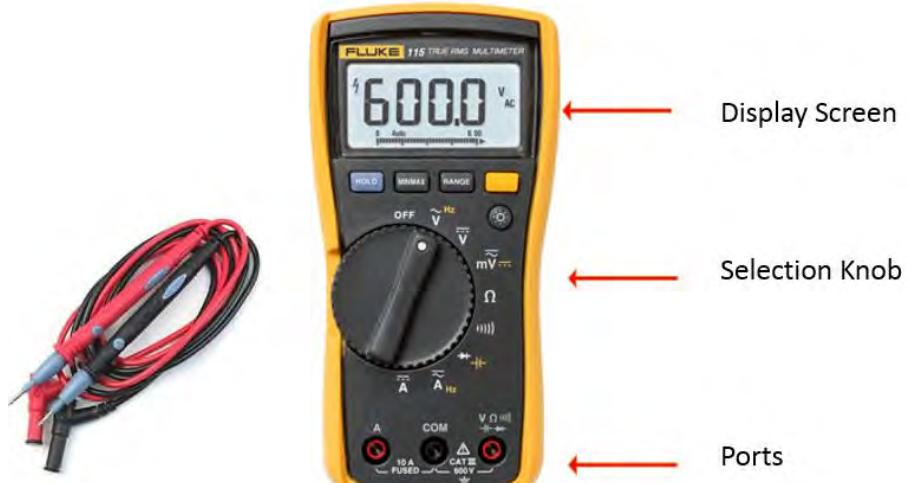
Fig. 2.4.2 Multimeter
